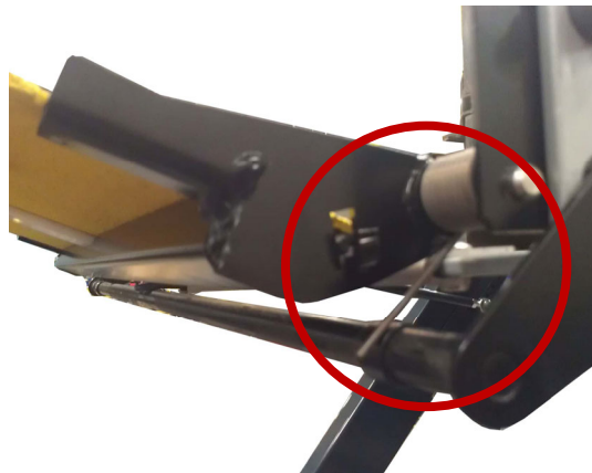
FIGURE 2-9. UNHOOK BRIDGEPLATE SPRING
