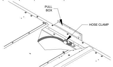
FIGURE 4-47: HOSE CLAMP AT PULL BOX
