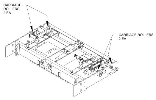
FIGURE 4-30: CARRIAGE ROLLER LUBRICATION
