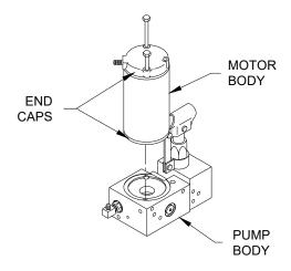
FIGURE 4-45: PUMP MOTOR ORIENTATION
