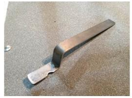
FIGURE 2-2A: HEIGHT GAUGE TOOL (P/N 56279)
