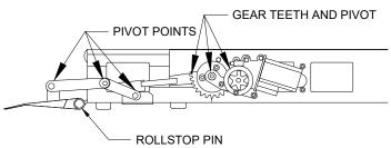
RIGHT SIDE FIGURE 4-4: ROLLSTOP LUBRICATION POINTS
